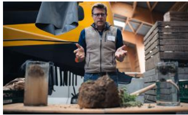
Durchführung eines Slake-Tests zum Vergleich der Struktur zweier Bodenarten. Die Probe aus regenerativer Landwirtschaft (rechts) zeigt eine bessere Bodenstruktur und ist weniger erosionsanfällig
